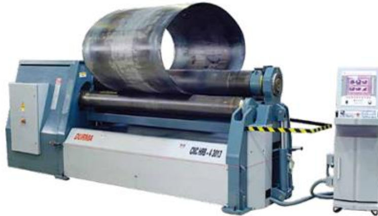
Slika 2. Kružno savijanje lima
